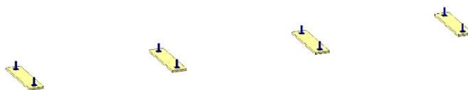
Опорные поверхности рам лесов должны находиться строго в одной горизонтальной плоскости.
